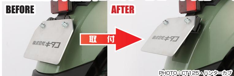
ナンバープレートの設置角度を傾けることができるナンバープレートステーです。
