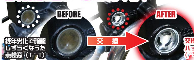
経年劣化で確認しずらくなった点検窓 (T<sup>TT</sup>)
